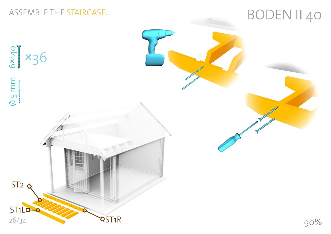
CUT THE BOARDS TO INSTALL THE STAIRCASE AGAINST THE WALL.
